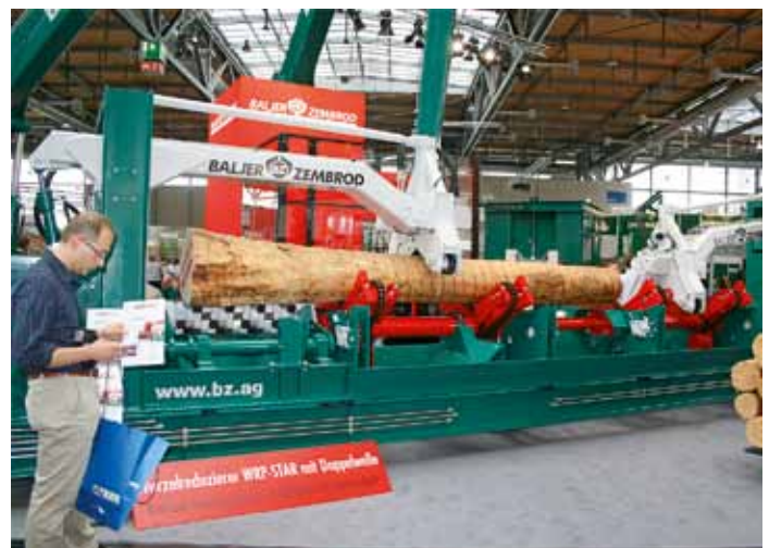
Der Wurzelreduzierer WRP-Star: Das patentierte, drehbare Sternprisma verkürzt die Taktzeiten um 30%
