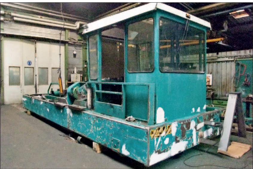
Gebrauchter Sortierwagen bei der Werksüberholung
