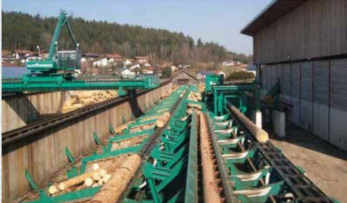
Von der Aufgabestation bis zu Sortierlinie und dann weiter mit dem Portalkran ins Sägewerk = 100.000 Festmeter mit nur einem Bediener auf dem Rundholzplatz.
