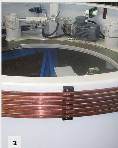
Fig. 2: L'alimentation du groupe est assurée par les bagues collectrices.
