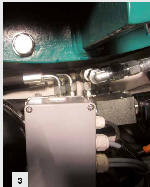
Fig. 3: Un distributeur commande les cinq vérins des bras avec couteaux pour l'ouverture et la fermeture. Cinq accumulateurs à membrane absorbent le débit d'huile de compensation des vérins différentiels. La pompe aspire (pendant le mouvement rotatif de l'ensemble du rotor) l'huile depuis un réservoir exempt d'air.
