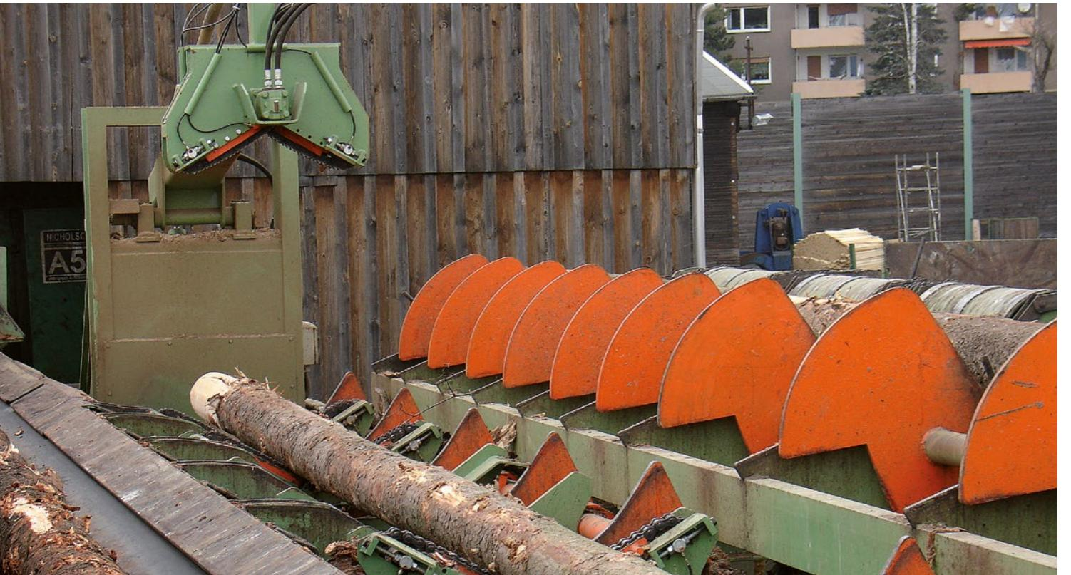
**Vysoký výkon reduktoru kořenových náběhů pro integraci do dopravníků s přičním průběhem, s přidržovačem (poháněná řetězová prizma)**
