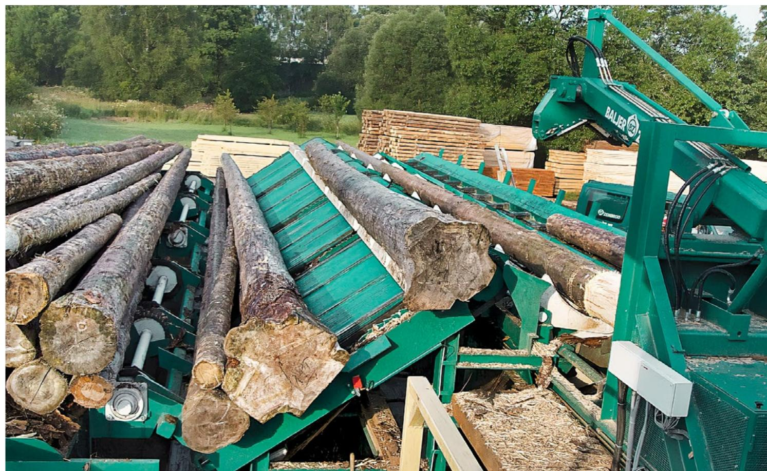
**Wurzelreduzierer zum Einbau in eine Förderanlage im Querdurchlauf mit Niederhalter (angetriebenes Kettenprisma)**
