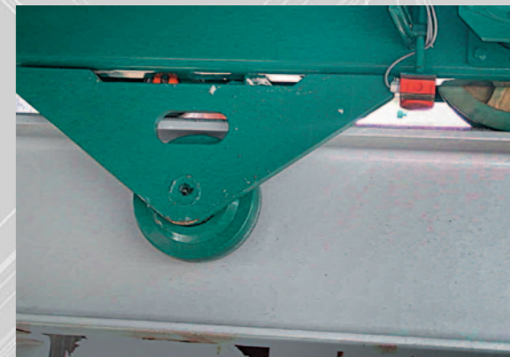
Gegenrollen als Kippsicherung zum sicheren Verfahren
